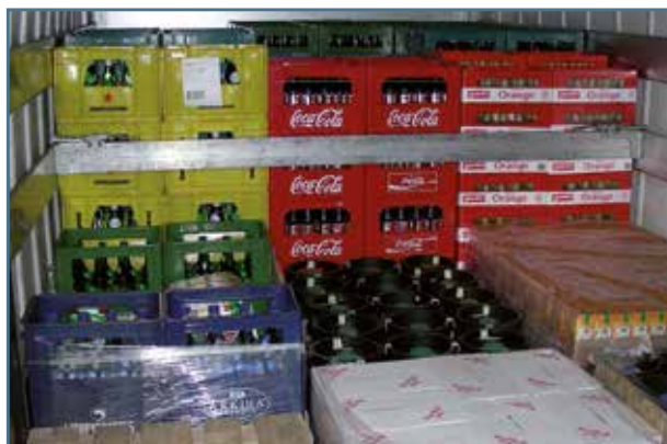
Rys. 13. Blokowanie poprzez ścianę przednią i specjalnie skonstruowaną barierę
