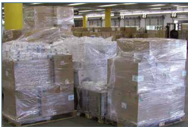
Rys. 52. Pakowanie za pomocą folii rozciągliwej.
