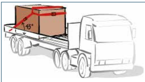
Rys. 26. Przykład mocowania szpringowego zabezpieczającego przed przesunięciem do przodu
