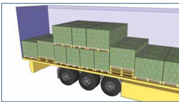
Rys. 17. Mocowanie progowe wyższej warstwy w kierunku do przodu
