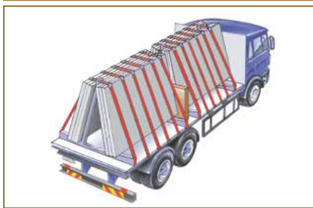
Rys. 63. Płyty zabezpieczone na platformie przez umiejscowienie urządzenia blokującego
