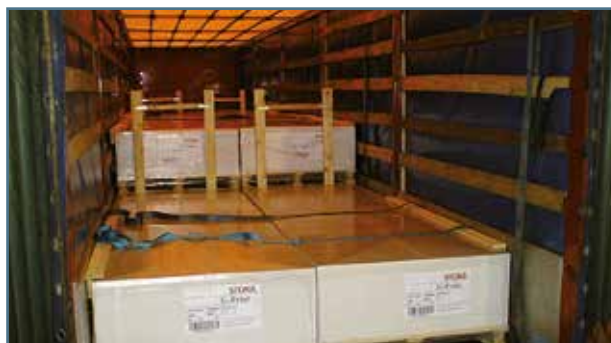
Rys. 19. Panel blokujący arkusze papieru na paletach
