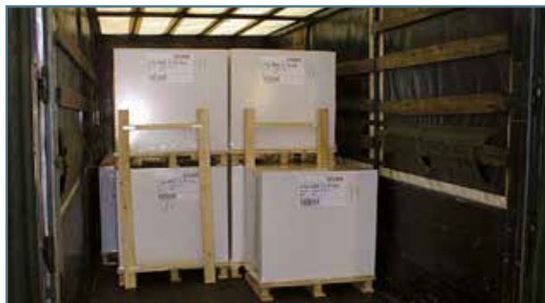
Rys. 18. Blokowanie panelowe drugiej warstwy w kierunku do przodu
