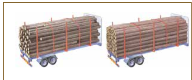
Rys. 66. Odciały powinny zawsze wytworzyć pionowe obciążenie na drewno okrągłe
