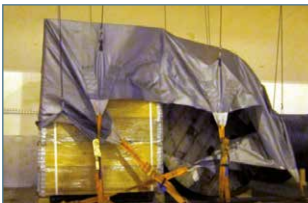
Rys. 42. System zabezpieczający z zintegrowanymi odciągami
