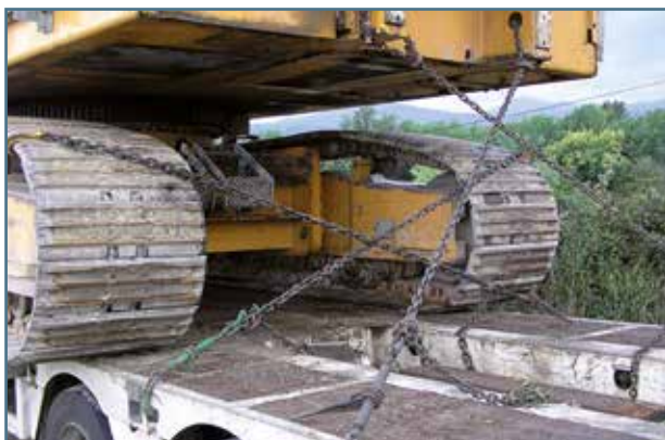
Rys. 39. Koparka zabezpieczona za pomocą łańcuchów zamocowanych ukośnie
