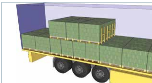
Rys. 18. Blokowanie panelowe drugiej warstwy w kierunku do przodu
