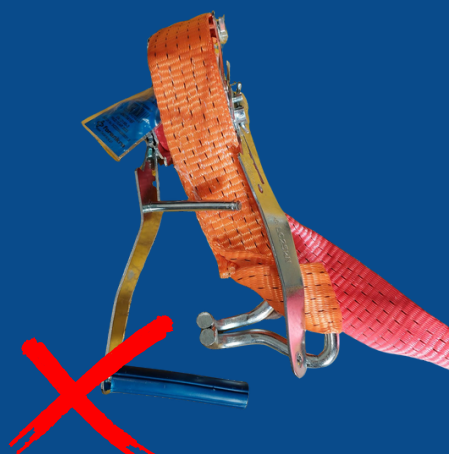
Uszkodzony napinacz Każde pęknięcie elementów metalowych/ramy/osi.
