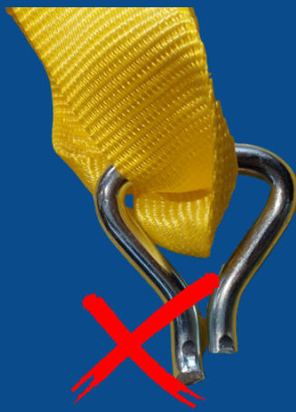
Uszkodzone zakończenie / hak Pęknięte, wygięte, odkształcone, nadmiernie skorodowane elementy końcowe.
