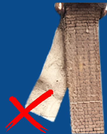
Brak lub nieczytelna etykieta Etykieta zerwana/nieczytelna = brak identyfikacji (LC, długość, norma)
