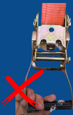
Odkkształcony napinacz Wygięte elementy, luzu lub zacinananie mechanizmu.
