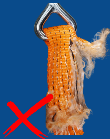
Postrzępione krawędzie Widoczne strzępienie włókien, rozwarstwienie, „puchnięcie” taśmy.
