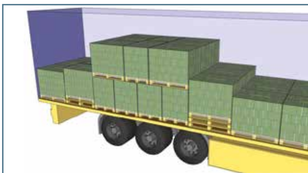
Рис. 17. Блокировка верхнего слоя за счет уступа в переднем направлении
