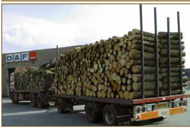
Рис. 69. Укладка лесоматериала поперек не рекомендуется!
