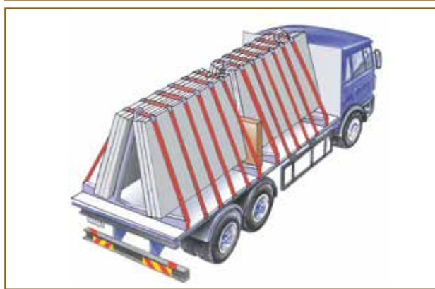
Рис. 63. Панели, укрепленные на платформе с помощью блокирующего элемента
