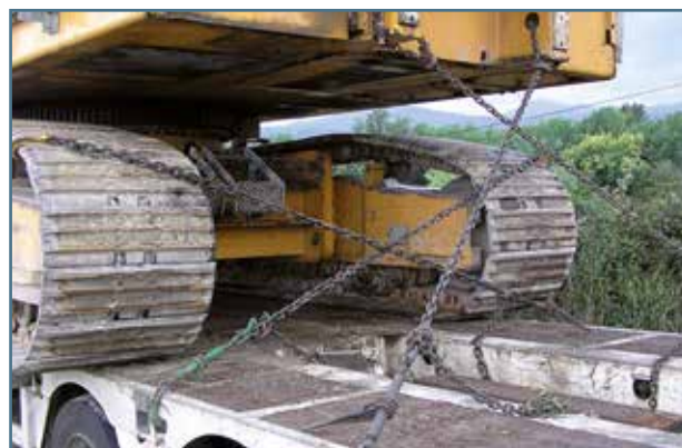
Рис. 39. Экскаватор, увязанный цепями по диагонали
