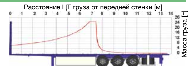
Рис.3. Пример схемы распределения груза – полуприцеп
