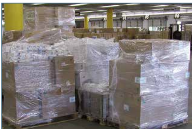
Рис. 52. Упаковка, затянутая растягивающейся пленкой
