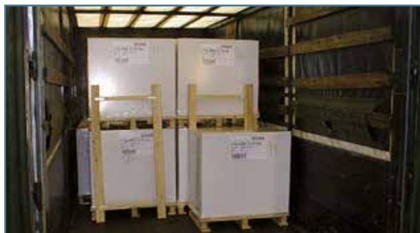
Рис. 18. Блокировка второго слоя в переднем направлении с помощью панелей
