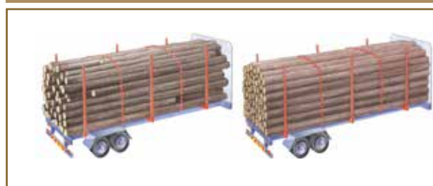
Рис. 66. Прижимные ремни должны всегда увеличивать вертикальную нагрузку на круглый лес
