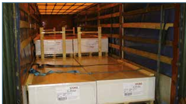
Рис. 19. Блокировка листов бумаги на поддонах с помощью панелей
