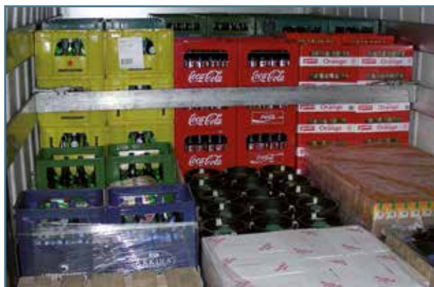
Рис. 13. Блокировка с помощью переднего борта и специально изготовленных перемычек
