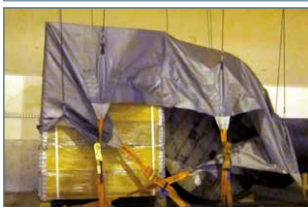
Рис. 42. Система удержания с приделанными ремнями
