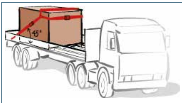
Рис. 26. Пример рессорной увязки, препятствующей движению вперед
