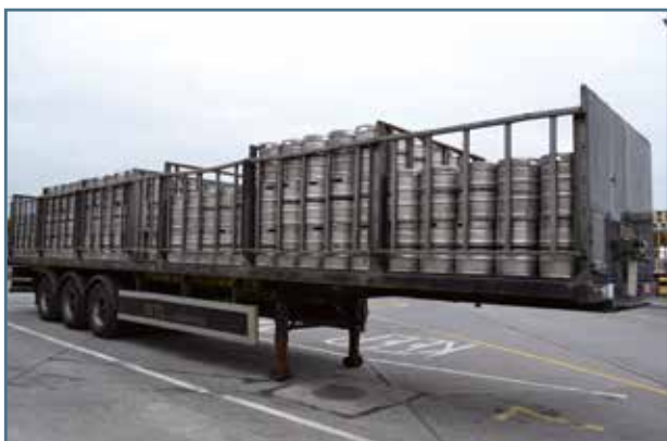
Рис. 12. Блокировка с помощью переднего борта и боковых бортов
