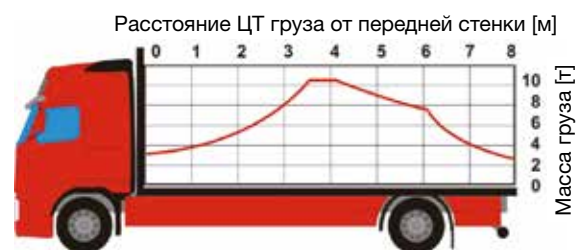
Рис. 2. Пример схемы распределения груза – двухосный автомобиль
