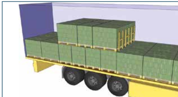
Рис. 18. Блокировка второго слоя в переднем направлении с помощью панелей
