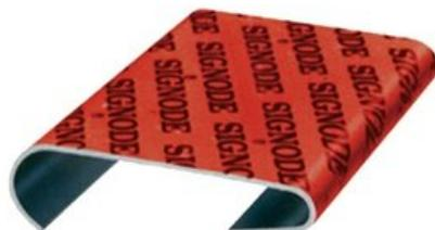
Die Signode 117 HDG OF-Clips mit offenem Kragen wurden speziell für die Verwendung mit dem pneumatischen Schweißgerät N-1444-5LSH auf Magnus 32-mm-Stahlbändern entwickelt. Offene Kragenplomben sind eine robuste Version der Schnappplomben. Diese Dichtungen werden vor oder nach der Riemenspannung an den überlappenden Enden des Riemens angebracht, wodurch ein Voreinfädeln entfällt und die Produktivität erhöht wird.
