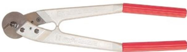
Schneidet sowohl hartgezogene Drähte wie Stahl-, Kupfer- und Aluminiumdrähte, Elektrokabel und mehrdrähtige Seile. Die Schneidkanten sind so geformt, dass sie das Seil beim Schneiden in Form eines Dreiecks greifen, was ein Aufdrehen des Seilendes verhindert. Die Schneiden sind aus legiertem Koromantstahl gefertigt und mit Kunststoffgriffen versehen.
