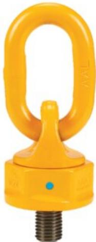
Allgemein: Aufgrund seines einzigartigen Lagerdesigns um bis zu 180° neigbar und um 360° drehbar. Alle Teile haben die Rissprüfung von Magnaflux bestanden. Jedes Teil enthält eine Kennung, die die Rückverfolgbarkeit gemäß Zertifikat gewährleistet. Getestet mit 2,5-facher Tragfähigkeit.
