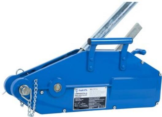
Hochwertige Aluminiumwinde zum Ziehen und Heben. Die Winde hat keine Seiltrommel, da das Seil durch das Gerät geführt wird. Die Hub- und Zuggeschwindigkeit beträgt ca. 3 m/min. Der Flaschenzug wird standardmäßig mit einem 20 m langen Stahlseil mit Ratschenhaken geliefert.
